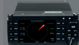
ACDU – jednostka sterująco-obrazująca
